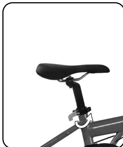
Стъпка 3 Затегнете здраво механизма за бързо разхлабване.
