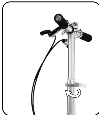
Стъпка 3 Блокирайте здраво механизма за бързо разхлабване
