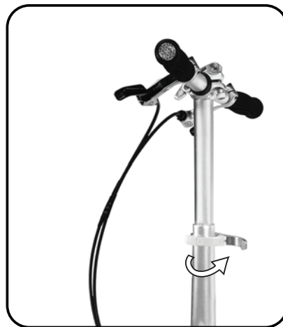
Стъпка 1 Отворете механизмът за бързо разхлабване.
