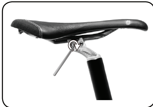
Стъпка 5 – Затегнете предварително смазаните болтове до 85 in/lbs или 9.5 NM.
