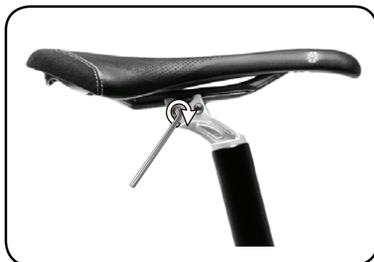
Trin 5 – Spænd de i forvejen smurte bolte til et moment af 0,95 kg.
