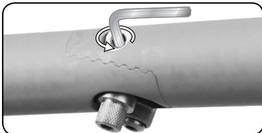
Öffnen Sie die OC-Schraube und drehen Sie sie um 180° im Gegenuhrzeigersinn.
