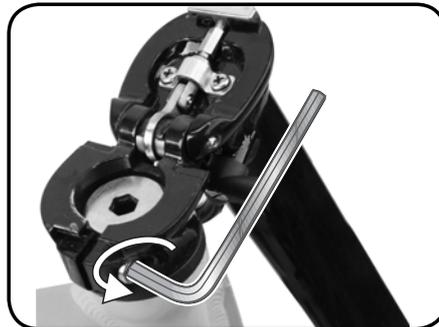
Schritt 1 – Öffnen Sie die Lenkerstützenklemme, wie oben abgebildet. Verwenden Sie hierzu einen 6-mm-Inbusschlüssel und drehen Sie die Klemme im Gegenuhrzeigersinn.
