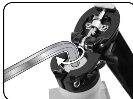
Schritt 2 – Geben Sie Loctite 222 (oder Loctite 242) auf die Steuerlagerschraube, wenn Sie diese festziehen. Befolgen Sie die obigen Pfeile und drehen Sie die Steuerlagerschraube im Uhrzeigersinn mit einem Drehmoment von 6,8 - 11,3 Nm fest.
