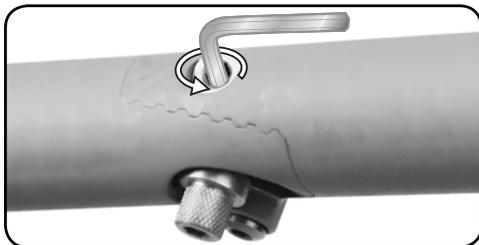
Öffnen Sie die OC-Schraube und drehen Sie sie um 180° im Gegenuhrzeigersinn.
