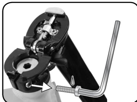
Schritt 3 – Geben Sie regelmäßig Loctite 222 (oder Loctite 242) auf die Klemmschraube. Nehmen Sie die Klemmschraube heraus und geben Sie einen kleinen Tropfen Loctite 222 (oder Loctite 242) auf das Schraubengewinde. Stecken Sie die Schraube anschließend wieder in die Klemme zurück.
