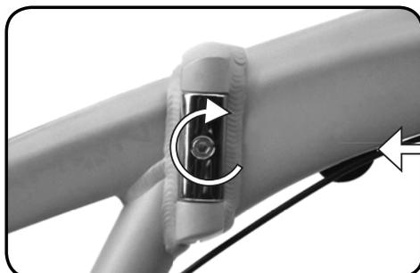
Schritt 3 - Ziehen Sie die Scharnierklemme mit einem 6-mm-Inbusschlüssel fest. Drehen Sie die Verstellmutter im Uhrzeigersinn.
