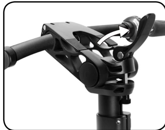
Schritt 1 - Öffnen Sie von hinten auf den Vorbau schauend den Sperrhebel oben auf dem Flat-Pak-Vorbau, indem Sie diesen nach rechts schieben.
