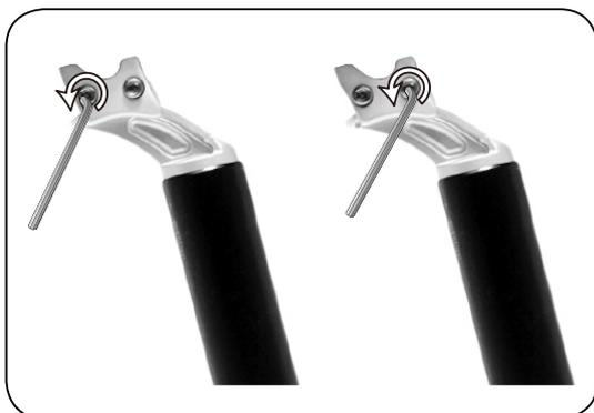
Schritt 1 - Lösen Sie die Schienenklemme des „Kore I-Beam“-Sattels mithilfe eines 4-mm-Inbusschlüssels.
