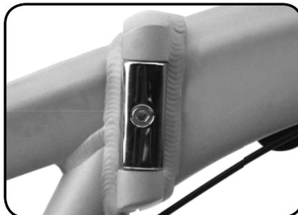
Die Scharnierklemme befindet sich vollständig an der Rahmenvorderseite, mit der Verstellmutter außen. Benutzen Sie zum Einstellen einen 6-mm-Inbusschlüssel.
