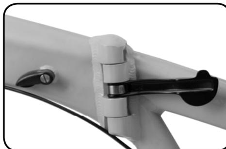
Schritt 2 - Schließen Sie das Scharnier: Schließen Sie den Verschluss nicht während dieses Vorgangs.
