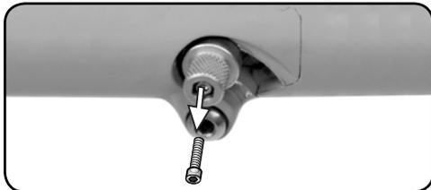
Entfernen Sie die Sicherungsschraube.
