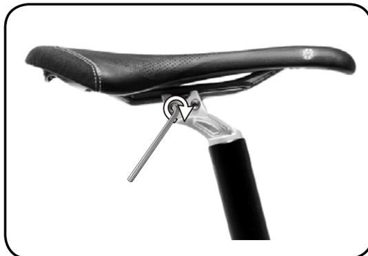
Schritt 5 - Ziehen Sie die vorher eingefetteten Schrauben mit einer Kraft von 9,5 Nm fest.
