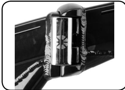
Nur eine Hälfte der Scharnierklemme befindet sich an der Rahmenrückseite.
