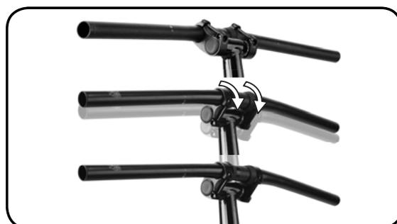
Schritt 3 - Stellen Sie die Höhe und Position des Lenkers auf Ihre bevorzugte Fahrposition ein. Verschieben Sie die VRO-Klemme innerhalb des Einstellbereichs - nach vorne, hinten, oben und unten.
