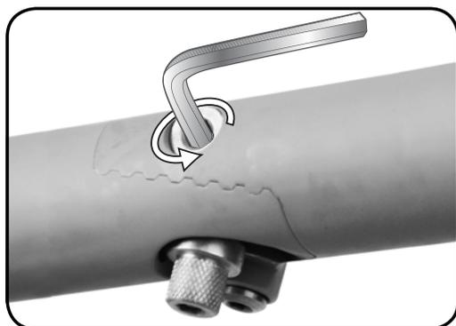
Durch Drehen der OC-Schraube um 180° im Gegenuhrzeigersinn kann das LockJaw-Scharnier geöffnet werden. Siehe obige Abbildung.
