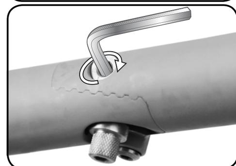
Schließen und öffnen Sie die OC-Schraube, um die richtige Spannung des LockJaw zu prüfen. Wenn die OC-Schraube am Ende hörbar schließt, ist die Spannung genau richtig. Sobald Sie die richtige Spannung haben, schließen Sie das LockJaw-Scharnier, indem Sie die OC-Schraube um 180° im Gegenuhrzeigersinn drehen.
