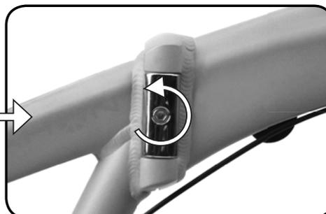
Schritt 3a - Lösen Sie die Scharnierklemme mit einem 6-mm-Inbusschlüssel, indem Sie die Verstellmutter im Gegenuhrzeigersinn drehen.
