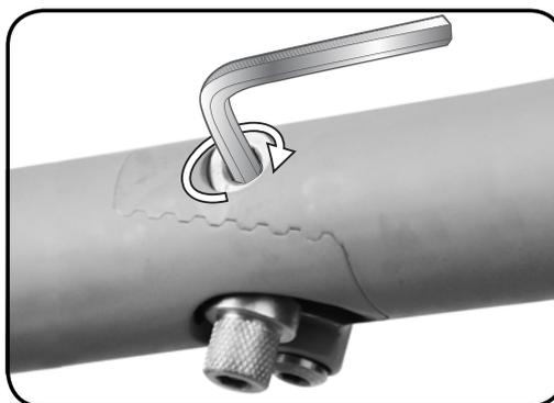
Zum Schließen des LockJaw-Scharniers, schließen Sie dieses einfach und drehen Sie die OC-Schraube um 180° im Uhrzeigersinn. Wenn Sie die Stellschraube richtig einstellen, sollte diese spürbar einrasten. Die Zähne des LockJaw-Scharniers greifen dabei ineinander. Siehe obige Abbildung.
