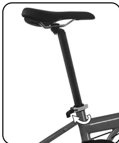
Βήμα 1 Ανοίξτε τον μηχανισμό ταχείας απασφάλισης
