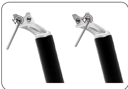
Βήμα 1 - Χρησιμοποιήστε ένα κλειδί Άλεν 4 χιλ. για να χαλαρώσετε τον σφικτήρα για τη ράγα της σέλας Kore I-beam
