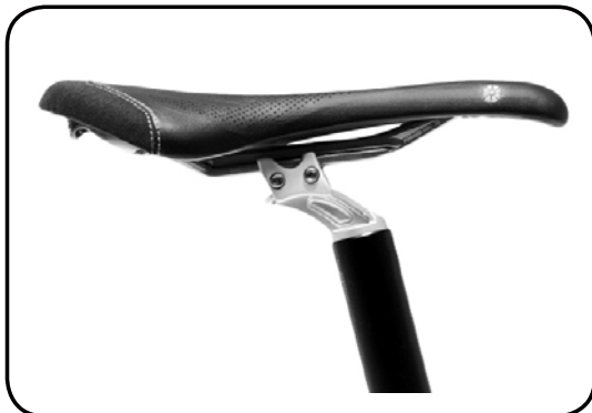
Βήμα 2 - Τοποθετήστε τη σέλα στις ράγες.
