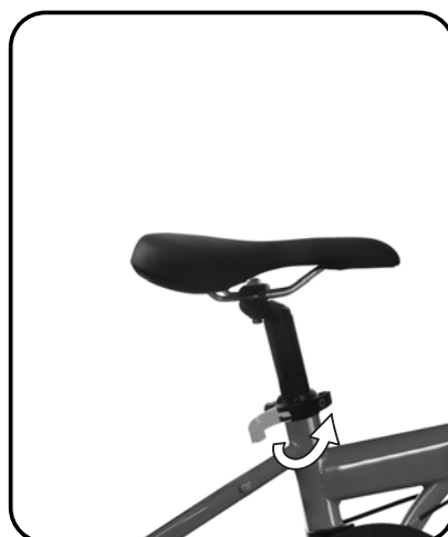
Βήμα 3 Κλείστε σφιχτά τον μηχανισμό ταχείας απασφάλισης
