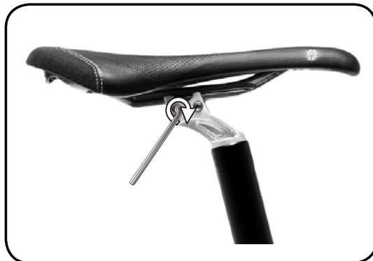
Βήμα 5 - Σφίξτε τις βίδες (έχουν ήδη γράσο) με ροπή 85 in/lbs ή 9,5 NM.
