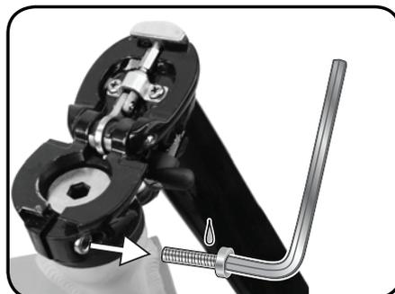
Paso 3: aplique regularmente Loctite 222 (Loctite 242 también sirve) al tornillo de la abrazadera. Saque el tornillo de la abrazadera, aplique una pequeña gota de Loctite 222 (o Loctite 242) en las roscas del tornillo y, a continuación, vuelva a colocarlo en la abrazadera.
