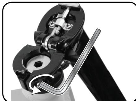
Paso 1: abra la abrazadera del manillar según la indicación anterior usando una llave allen de 6mm girando en sentido horario.
