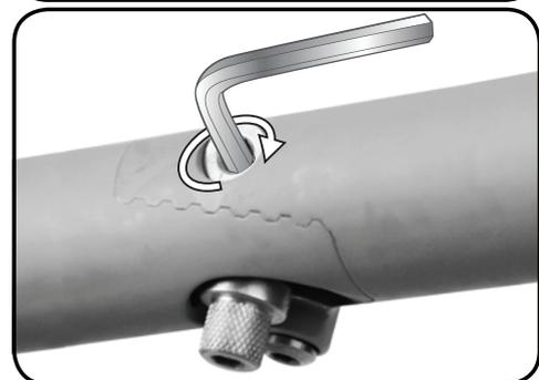
Para comprobar si la presión de la bisagra LockJaw es la adecuada, cierre y abra el tornillo OC. Cuando el tornillo OC se cierre emitiendo un clic al final, la presión es correcta. Una vez se alcanzada la presión adecuada, cierre la bisagra LockJaw girando el tornillo OC 180° en sentido anti horario.
