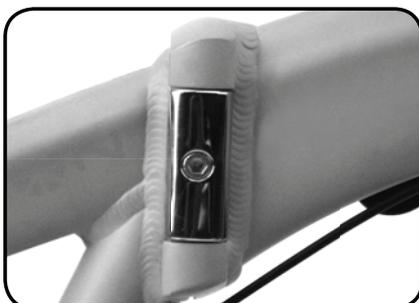
La abrazadera de la bisagra está toda colocada en la parte de delante del cuadro, con la tuerca de ajuste por fuera. Para el ajuste, emplee una llave allen de 6mm.
