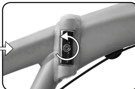
Paso 3: para aflojar la abrazadera de la bisagra, use una llave allen de 6mm y gire la tuerca de ajuste en sentido anti horario.
