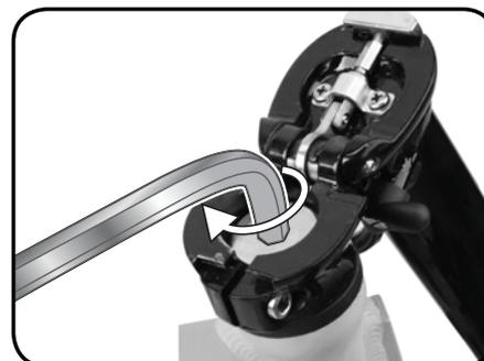
Paso 2: aplique Loctite 222 (Loctite 242 también sirve) cuando apriete el tornillo del buje. Siga la flecha de arriba y gire el tornillo del buje en sentido horario para apretarlo aplicando un par de apriete de 6,8-11,3 Nm.
