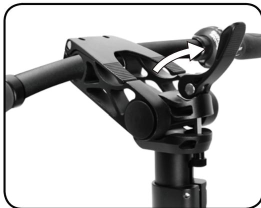
Paso 1: colóquese de cara a la posición de manejo, abra la maneta de bloqueo situada en la parte superior de la dirección Flat Pak y tire de ella hacia usted.
