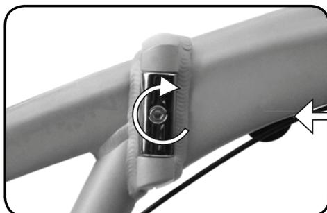
Paso 3: para apretar la abrazadera de la bisagra, use una llave allen de 6mm. Gire la tuerca de ajuste en sentido horario.
