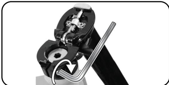
Paso 5: siga la flecha de arriba y apriete el tornillo de la abrazadera girándolo en sentido horario. Apriete el tornillo aplicando un par de apriete de 11,3 Nm.
