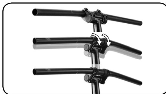
Étape 3 – Réglez la hauteur et la position du guidon à votre position de conduite préférée. Déplacez la fixation VRO dans la plage de réglage - avant, arrière, haut, et bas.
