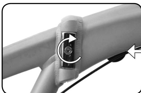
Étape 3 (Serrer) – Réglez la charnière : Utilisez une clé hexagonale de 6 mm. Tournez l'écrou de réglage dans le sens des aiguilles d'une montre.
