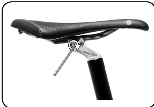
Étape 5 - Serrez les boulons à une pression de 85 po/lb ou 9,5 NM.
