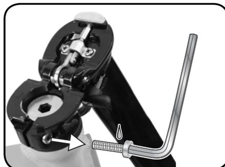
Étape 3 - Appliquez occasionnellement un peu de Loctite 222 (Loctite 242 est aussi acceptable) sur la vis de fixation. Dans ce cas, retirez la vis de fixation et placez une petite goutte de Loctite 222 (ou Loctite 242) sur le fl de cette vis. Remplacez ensuite la vis de fixation.
