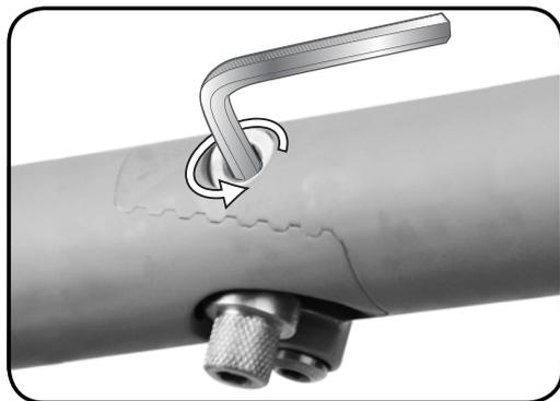
Pour ouvrir la charnière LockJaw, tournez le boulon OF de 180° dans le sens contraire des aiguilles d'une montre. Voir la figure ci-dessus.
