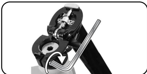
Étape 5 - Serrez la vis de fixation dans le sens horaire tel qu'indiqué par la flèche. Serrez la vis avec un couple de 11,3 Nm.
