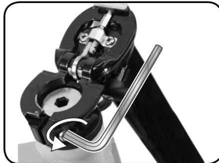
Étape 1 - Ouvrez premièrement la fixation de la tige du guidon. Desserrez la vis de fixation avec une clé hexagonale de 6 mm en tournant dans le sens inverse des aiguilles d'une montre tel qu'indiqué par la flèche.
