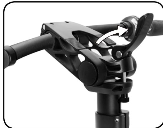
Étape 1 – Placez le Levier de fixation contre la tige de la position conduite et ouvrez-le au dessus de la tige Flat Pak en le tirant vers vous.
