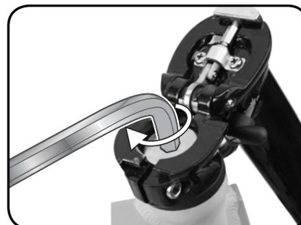
Étape 2 - Appliquez un peu de Loctite 222 (Loctite 242 est aussi acceptable) sur la vis de serrage du jeu de direction. Tournez la vis du jeu de direction dans le sens horaire tel qu'indiqué par la flèche. Serrez la vis avec un couple de 6,8~11,3 Nm.
