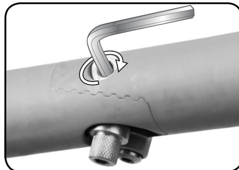
Pour s'assurer de la bonne tension de la charnière LockJaw, serrez et desserrez le boulon OF. Lorsqu'un clic est produit à la fin du serrage du boulon OF, alors sa tension est bonne. Une fois que vous avez trouvé la bonne tension, serrez la charnière LockJaw en tournant le boulon OF à 180° dans le sens contraire des aiguilles d'une montre.
