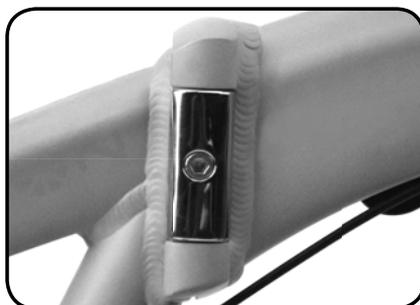
Vis de la charnière complètement sur la partie avant du cadre. L'écrou de réglage est sur l'extérieur. Une clé hexagonale de 6 mm est nécessaire pour l'ajuster.
