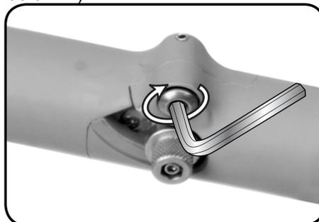
Étape 2 (Serrer) - Tournez le boulon du pivot dans le sens des aiguilles d'une montre pour le serrer tel qu'indiqué ci-dessus (clé hexagonale de 6 mm).
