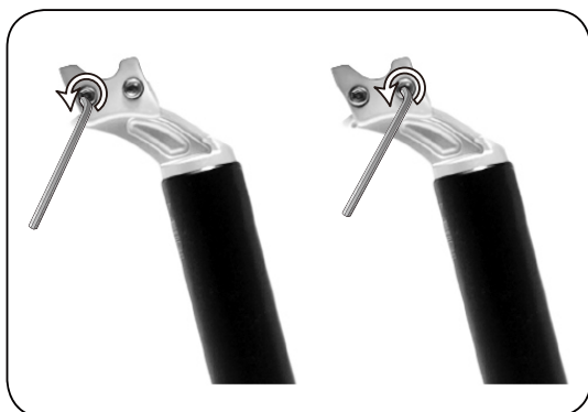
Stap 1 - Draai de Kore I-beam-klembout los met een 4 mm inbussleutel.
