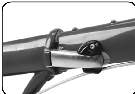
JUNTA DO QUADRO FECHADA
