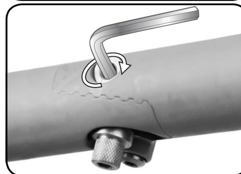
Pentru a verifica tensiunea corectă a balamalei LockJaw, închideți și deschideți șurubul OC. Atunci când șurubul OC se închide cu un „clic” la final, tensiunea este corectă. Atunci când obțineți tensiunea corectă, închideți balamaua LockJaw răsucind șurubul OC la 180° în sens contrar acelor de ceasornic.
