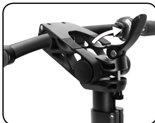
Pasul 1 - Atunci când vă aflați cu fața la pipă din poziția de mers, deschideți maneta de blocare de deasupra pipei Flat Pak trăgând-o spre dumneavoastră.
