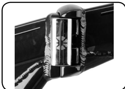
Doar jumătate din clema balamalei este poziționată în partea posterioară a cadrului.
