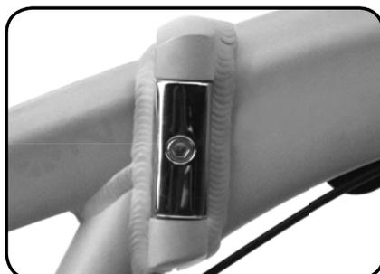
Clema balamalei este poziționată în totalitate în partea din față a cadrului, iar piulița de reglare se află în exterior. Pentru reglare, folosiți o cheie inbus de 6 mm.
