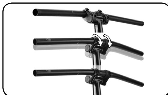
Pasul 3 - Reglați înălțimea și poziția ghidonului pentru a obține poziția preferată. Deplasați clema VRO în intervalul de reglare - față, spate, sus și jos.
