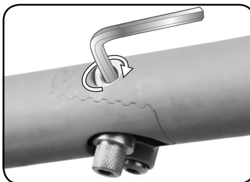
Pentru a bloca balamaua LockJaw, este suficient să închideți balamaua și să răsuciți șurubul OC la 180° în sensul acelor de ceasornic. Dacă reglați corect șurubul de reglare ar trebui să simțiți un clic. Dinții balamalei LockJaw se fixează în poziție. Consultați figura de mai sus.
