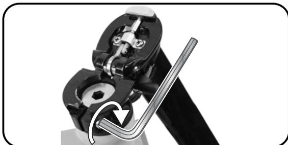
Korak 5 - V smeri zgornje puščice zategnite vijak objemke z vrtenjem v sourni smeri. Vijak zategnite z navorom 11,3 Nm.
