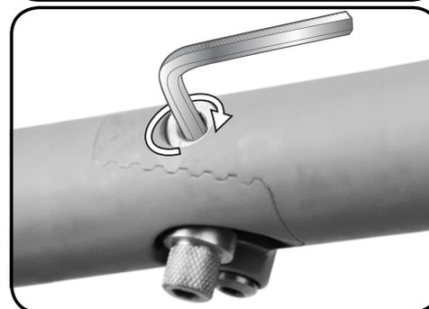
Pravilno zategnjenost sistema LockJaw preverite tako, da odprete in zaprete vijak OC. Če se vijak OC zapre z "klikom" na koncu, je nastavni vijak pravilno zategnjen. Ko ste dosegli ustrezno napetost, zaprite LockJaw tako, da zavrtite vijak OC za 180° v protiurnem smislu.
