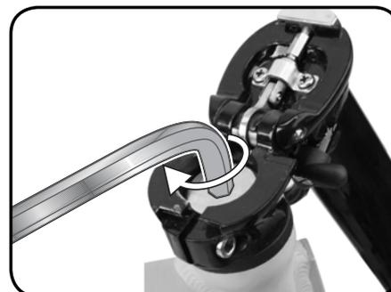
Korak 2 - Ko zategujete vijak krmilne opore, uporabite Loctite 222 (Loctite 242 je tudi sprejemljiv). V smeri zgornje puščice zategnite vijak krmilne opore z vrtenjem v sourni smeri z navorom 6,8 - 11,3 Nm.
