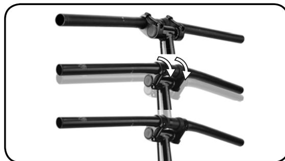
Korak 3 - Nastavite višino in lego krmila v želeno lego pri vožnji. Premaknite objemko VRO v obsegu možnih nastavitvev - naprej, nazaj, navzgor in navzdol.
