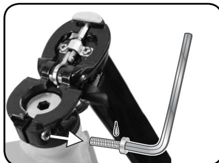
Korak 3 - Ko zategujete vijak objemke, uporabite Loctite 222 (Loctite 242 je tudi sprejemljiv). Izvlecite vijak objemke, spustite majhno kapljico Loctite 222 (ali Loctite 242) na navoj vijaka in nato vstavite vijak spet v objemko.
