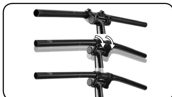
Askel 3 – Säädä ohjaustangon korkeus ja asento halutun laiseksi. Siirrä VRO-puristinta säätövaran puitteissa – eteen, taakse, ylös ja alas.
