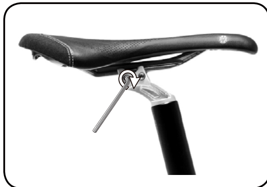
Steg 5 - Dra åt de försmörjda bultarna till 85 in/lbs eller 9,5 NM.
