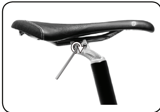
Krok 5 - Utáhněte předem vazelínou namazané šrouby utahovací silou 85 in/lbs nebo 9,5 Nm.
